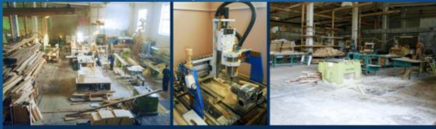
Экспериментально-столярный участок производит обработку (шлифовка, покраска, лакировка и т.п.) и изготовление мебели различной сложности.
